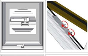
7. Regulierung der Drehstärke und Position des arretierten Drehens (max. 1 Mal 1 Umdrehung)
