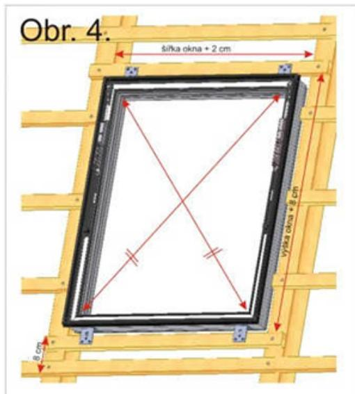
Bereiten Sie die Öffnung für das Einsetzen des Rahmens vor, wie in Bild 4 dargestellt. Befestigen Sie den Rahmen mit Holzschrauben an den Latten, jeweils drei Holzschrauben auf einen Montagewinkel. **ACHTUNG:** Es ist notwendig, auf richtige Zentrierung zu achten, und der Abstand der Diagonalen darf nur einen maximalen Unterschied von 1 mm aufweisen.
