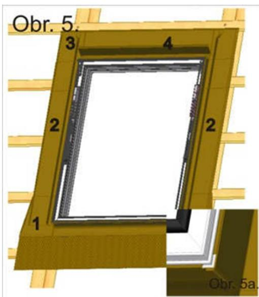
Nehmen Sie bei Montage des Besatzes zuerst gemäß Bild 5a die Rahmenabdichtung heraus und setzen Sie die einzelnen Teile des Besatzes nach und nach ein, siehe die Folgenummer auf dem Bild 5. **ACHTUNG:** Ein fehlendes Teil Nr. 4 kann zu Undichtheit des Fensters führen.
