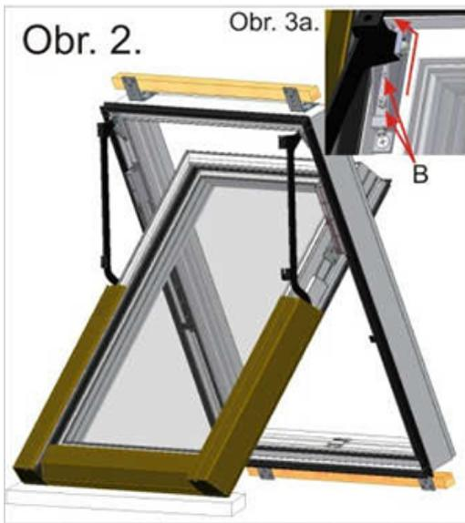
Lockern Sie, nachdem Sie den oberen Teil der Blechverkleidung entfernt haben, die Sicherungsschrauben B und koppeln Sie den Beschlag, wie in Bild 3a gezeigt, ab. Das müssen Sie zugleich auf der linken und rechten Seite durchführen. Nehmen Sie den Flügel vorsichtig heraus und legen Sie ihn auf eine saubere und weiche Unterlage. Lösen Sie jetzt die obere und untere hölzerne Transportleiste.
