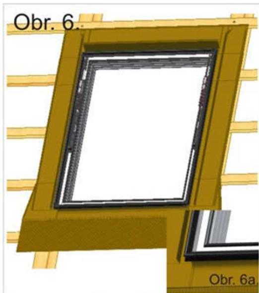
Nach dem Einsetzen der einzelnen Teile des Besatzes, legen Sie die Rahmenabdichtung gemäß Bild 6a wieder ein.
