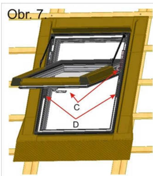
Beim Wiedereinbau des Flügels gehen Sie in der umgekehrten Reihenfolge, wie in Bild 3 dargestellt, vor. Achten Sie besonders darauf, dass die Walzen des Beschlages C sich ideal im abgegrenzten Raum auf der glatten Unterlage D bewegen. Halten Sie den Flügel an den Seiten und legen Sie das Spannsegment in das Loch, wie in Bild 3a dargestellt. Schrauben Sie dann die Sicherungsschrauben B gemäß Bild 3 ein.
